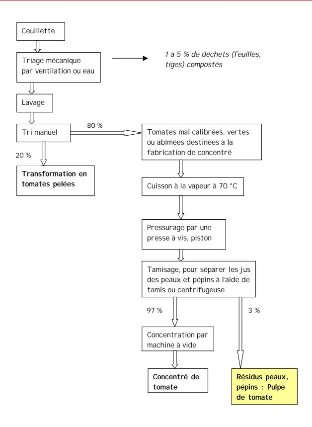
Figure 1 : Processus de fabrication de la pulpe de tomate
